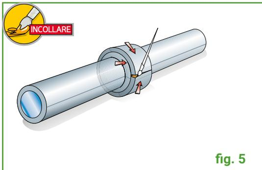
La striscia così ottenuta sarà applicata attorno alla flangia, spalmando prima accuratamente la colla nei punti di contatto con le due corone montate in precedenza.
