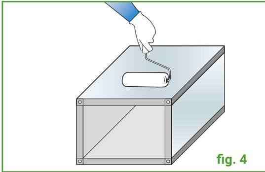
L'unione ideale della lamiera con l'isolante andrebbe effettuata per calandratura, pressando i due strati con un rullo (**fig. 4**).
