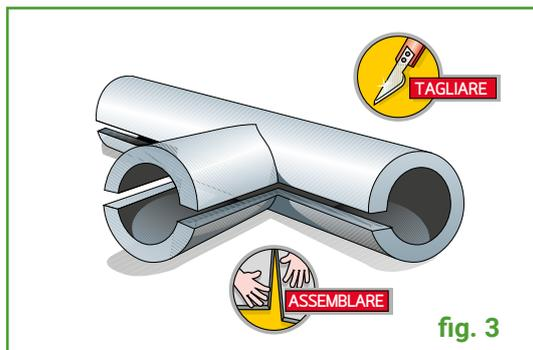
Assemblare le due parti, ottenendo così la diramazione a "T". Tagliare il manufatto in senso longitudinale al fine di consentire il montaggio. (fig 3)
