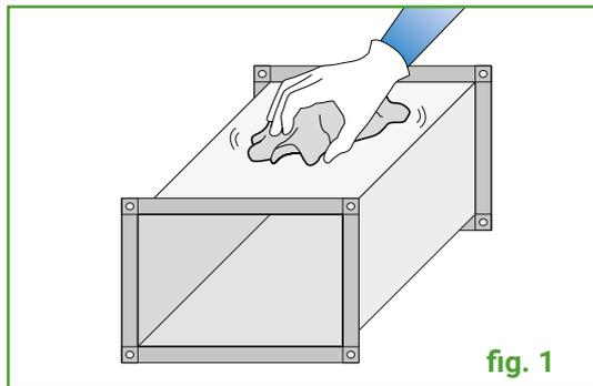
Per la misura e il taglio del materiale procedere come per il materiale adesivo (vedi paragrafo 4.2). Pulire tutte le superfici esterne del canale passandole se possibile alla fiamma per rimuovere tracce di grasso, olio, polvere e altra sporcizia (**fig. 1**). Assicurarsi che siano asciutte prima di applicare il materiale.
