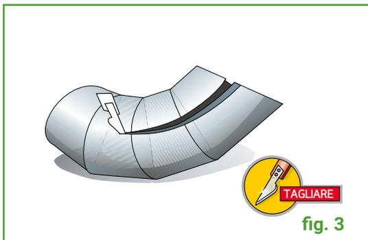
Praticare un taglio longitudinale, in modo da poter montare il manufatto sul tubo curvo e poi incollare (fig 3).
