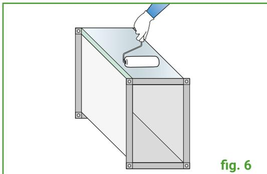
L'adesivo utilizzato è presso-sensitivo, per cui occorre esercitare una pressione adeguata e uniforme su tutta la superficie dell'isolante. Non è tanto importante l'entità della pressione quanto l'uniformità di distribuzione in ogni punto, al fine di evitare il formarsi di sacche d'aria. L'unione ideale della lamiera con l'isolante andrebbe effettuata per calandratura, pressando i due strati con un rullo(**fig. 6**). Ripetere l'operazione dal lato opposto del canale
