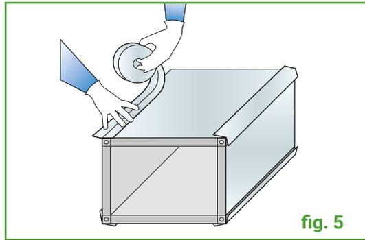
Rifinire le giunzioni di materiale con fasce adesive e nastri idonei, della stessa finitura superficiale del materiale installato (**fig. 5**). Per tagliare i nastri alla lunghezza richiesta utilizzare una forbice/coltello evitando di tirare e strappare il nastro stesso. Applicare una pressione uniforme su tutta la lunghezza del nastro per farlo aderire correttamente una volta posato.
