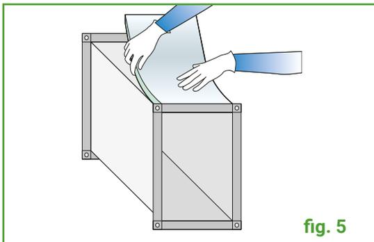
Premere saldamente mentre si rimuove la pellicola protettiva continuando ad allineare il materiale lungo la condotta. (**fig. 5**).
