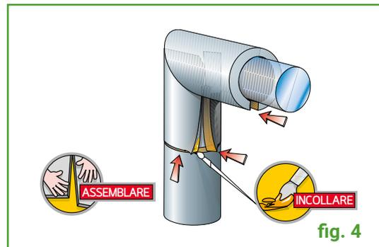
Rivestire il gomito con il pezzo ottenuto, incollare i bordi del taglio premendoli per farli ben aderire e raccordare con altre guaine rettilinee dello stesso diametro (fig 4)
