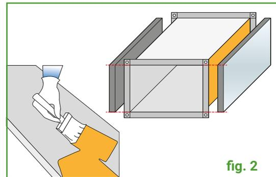
Mescolare la colla MATIBLOCK® e stenderne uno strato sottile sulla superficie in metallo e sulle prime due porzioni di materiale isolante (**fig. 2**). Una volta asciutto l'adesivo, (vedi corretto utilizzo della colla MATIBLOCK®) allineare il materiale isolante Trocellen e premere saldamente e uniformemente per un buon incollaggio.
