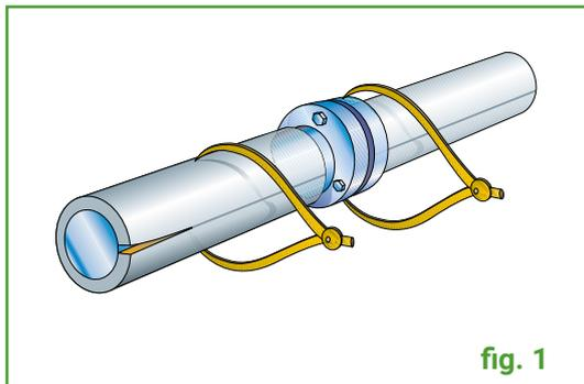
Isolare i due tratti di tubo fino alla flangia. Misurare il diametro della flangia e della tubatura isolata. (**fig 1**)
