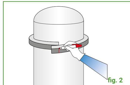
Misurare la parte cilindrica del serbatoio. Per le misurazioni, utilizzare una striscia di materiale isolante dello stesso spessore di quello da applicare e fare riferimento a quanto scritto sull'installazione dei canali a sezione circolare. (**fig. 2**)
