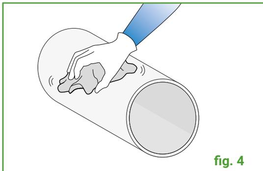
Pulire la superficie del canale, passandola ove possibile alla fiamma per rimuovere tracce di grasso, olio, polvere e altra sporcizia (**fig. 4**). Assicurarsi che sia asciutta prima di applicare il materiale.
