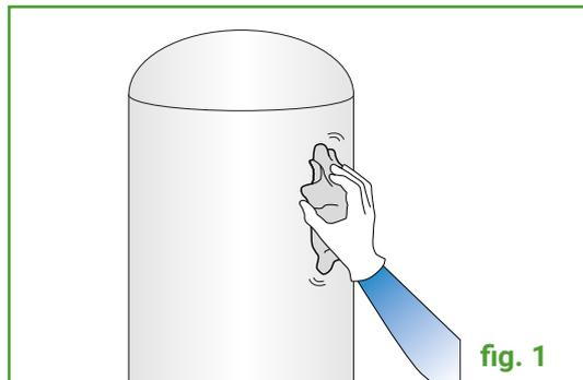
Precedentemente all'installazione dell'isolante, è necessario che il serbatoio sia pulito: se possibile, passare a fiamma le superfici esterne per rimuovere tracce di grasso, olio, polvere e altra sporcizia (**fig. 1**)
