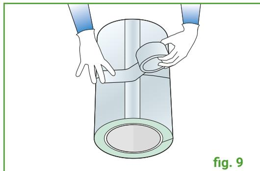
Per tagliare i nastri alla lunghezza richiesta utilizzare una forbice/coltello evitando di tirare e strappare il nastro stesso. Applicare una pressione uniforme su tutta la lunghezza del nastro per farlo aderire correttamente una volta posato. Applicare fasce e nastri anche nelle giunzioni trasversali tra porzioni consecutive di materiale isolante (**fig. 9**).
