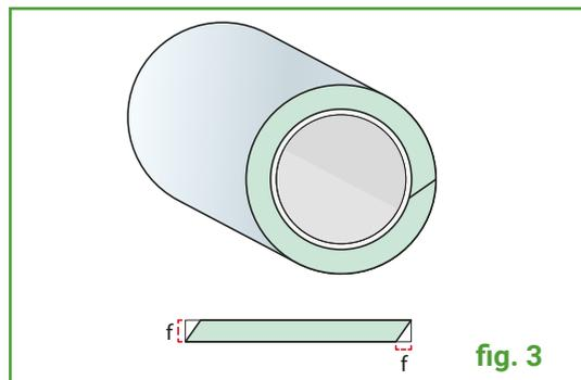
Se lo spessore del materiale è superiore ai 20 mm, si consiglia di praticare un taglio inclinato a 45° sui bordi che andranno a congiungersi per aumentare la superficie di adesione (**fig. 3**). Occorre perciò aggiungere alla lunghezza individuata con il metodo della striscia una misura pari allo spessore del materiale.
