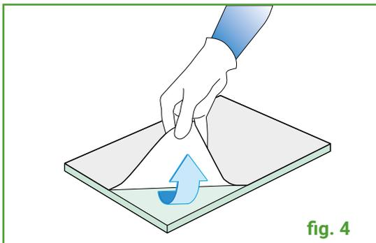
Rimuovere i primi 20 cm di pellicola protettiva (**fig. 4**) e allineare il materiale alla condotta posizionandone il lato scoperto al principio del tratto di canale, bene al di sotto della flangia.
