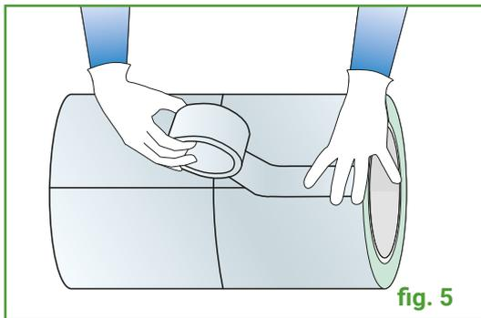
Premere uniformemente i due lembi per realizzare il giunto, e rifinire con fasce adesive idonee, della stessa finitura superficiale del materiale installato (fig. 5)
