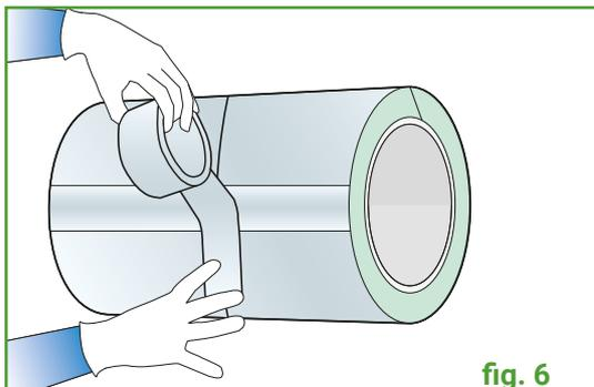
Per tagliare i nastri alla lunghezza richiesta utilizzare una forbice/coltello evitando di tirare e strappare il nastro stesso. Applicare una pressione uniforme su tutta la lunghezza del nastro per farlo aderire correttamente una volta posato. Applicare fasce e nastri anche nelle giunzioni tra porzioni consecutive di materiale isolante (fig. 6)
