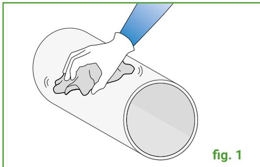
Pulire la superficie del canale, passandola ove possibile alla fiamma per rimuovere tracce di grasso, olio, polvere e altra sporcizia (**fig.1**).
