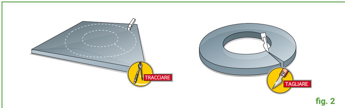
Con un compasso, **tracciare** sulla lastra due cerchi concentrici di diametro pari, rispettivamente, a quello della flangia e a quello della tubazione. **Ritagliare**, con una lama, la corona circolare ottenuta dalla tracciatura. Praticare un **taglio di apertura** al fine del successivo montaggio (**fig 2**).
