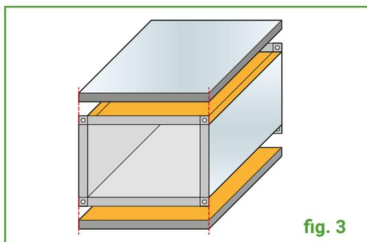
Proseguire allo stesso modo sulle altre due superfici (**fig. 3**) spalmando la colla anche sui bordi del materiale già posato e lasciando asciugare prima di unire le lastre premendo saldamente in posizione.
