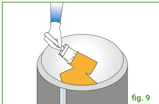
Applicare collante MATIBLOCK® sia sul materiale isolante che sulla superficie metallica (fare riferimento al paragrafo Corretto utilizzo della colla MATIBLOCK®) (**fig. 8, 9**).
