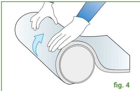
Una volta che il collante risulta asciutto, applicare il materiale isolante al canale facendo combaciare le parti su cui è stato steso l'adesivo. Premere saldamente e uniformemente per un buon incollaggio. Proseguire avvolgendo il materiale attorno alla condotta fino alla giunzione dei due lembi precedentemente spalmati con la colla. (fig. 4).
