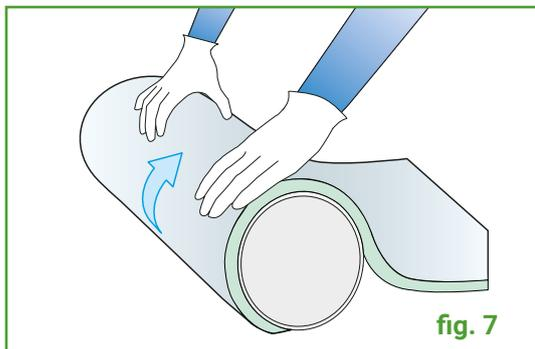
Appoggiarvi la condotta da isolare e richiudere l'isolante attorno alla condotta fino alla giunzione dei due lembi (**fig. 7**). L'adesivo utilizzato è presso-sensitivo, per cui occorre esercitare una pressione adeguata e uniforme su tutta la superficie dell'isolante. Non è tanto importante l'entità della pressione quanto l'uniformità di distribuzione in ogni punto, al fine di evitare il formarsi di sacche d'aria.
