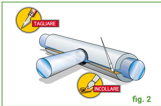
Tagliare la guaina in senso longitudinale e montarla sulla tubazione. Spalmare con la colla i bordi tagliati e incollare (fig 2)
