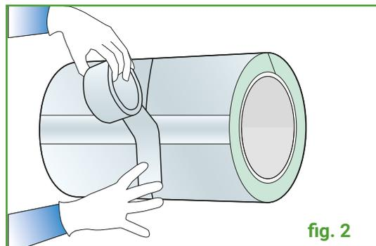
Rifinire la giunzione dello strato più esterno con una fascia adesiva idonea, della stessa finitura superficiale del materiale installato. Per tagliare i nastri alla lunghezza richiesta utilizzare una forbice/coltello evitando di tirare e strappare il nastro stesso. Applicare fasce e nastri anche nelle giunzioni tra porzioni consecutive di materiale isolante (**fig. 2**).
