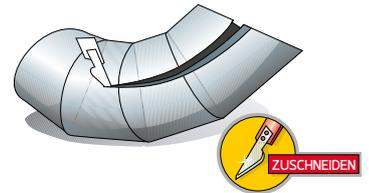
3 Schneiden Sie den Abschnitt längs nach unten hin passend zum Rohr ein und tragen Sie Klebstoff auf.
