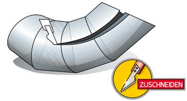
3 Schneiden Sie den Abschnitt längs nach unten hin passend zum Rohr ein und tragen Sie Klebstoff auf.
